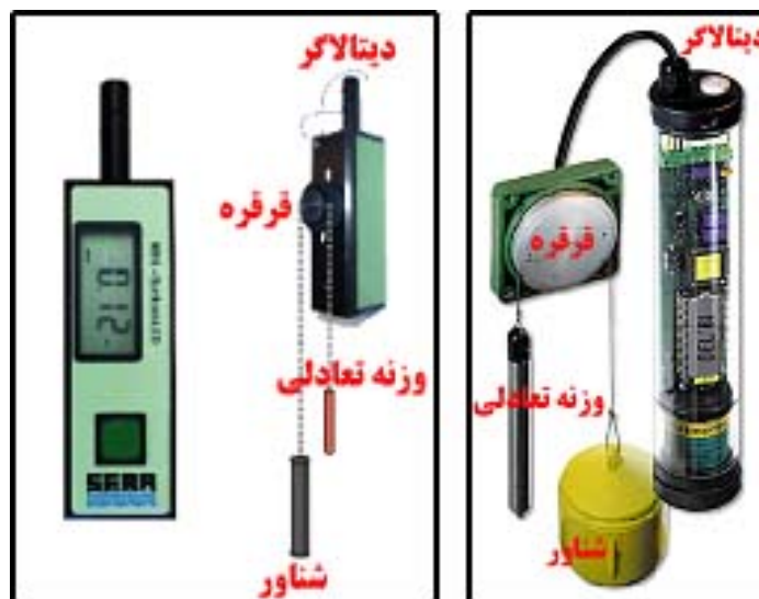
شکل ۸- دستگاه های سطح سنج الکترونیکی با سنسور شفت انکودر منصوب در ایستگاه های هیدرومتری استان گلستان
