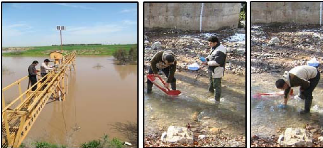
شکل ۱- اندازه گیری سیلاب در ایستگاه هیدرومتری آق قلا با استفاده از دستگاه مولینه ( سمت چپ ) و اندازه گیری رسوب معلق و بار کف در ایستگاه هیدرومتری سرمو با استفاده از دستگاه هلی اسمیت ( سمت راست )
