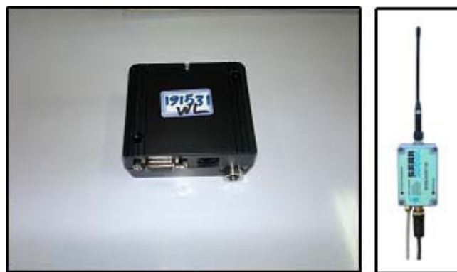
شکل ۹- دستگاه های مودم GSM منصوب در ایستگاه های هیدرومتری استان گلستان
