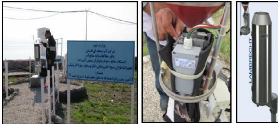
شکل ۲- نمونه از دستگاه باران سنج الکترونیکی با فناوری تیپینگ باکت - ایستگاه آشوراده
